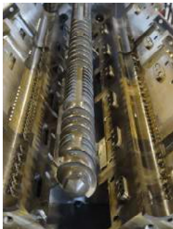
Co-malaxeur pour extrusion de systèmes fortement chargés
