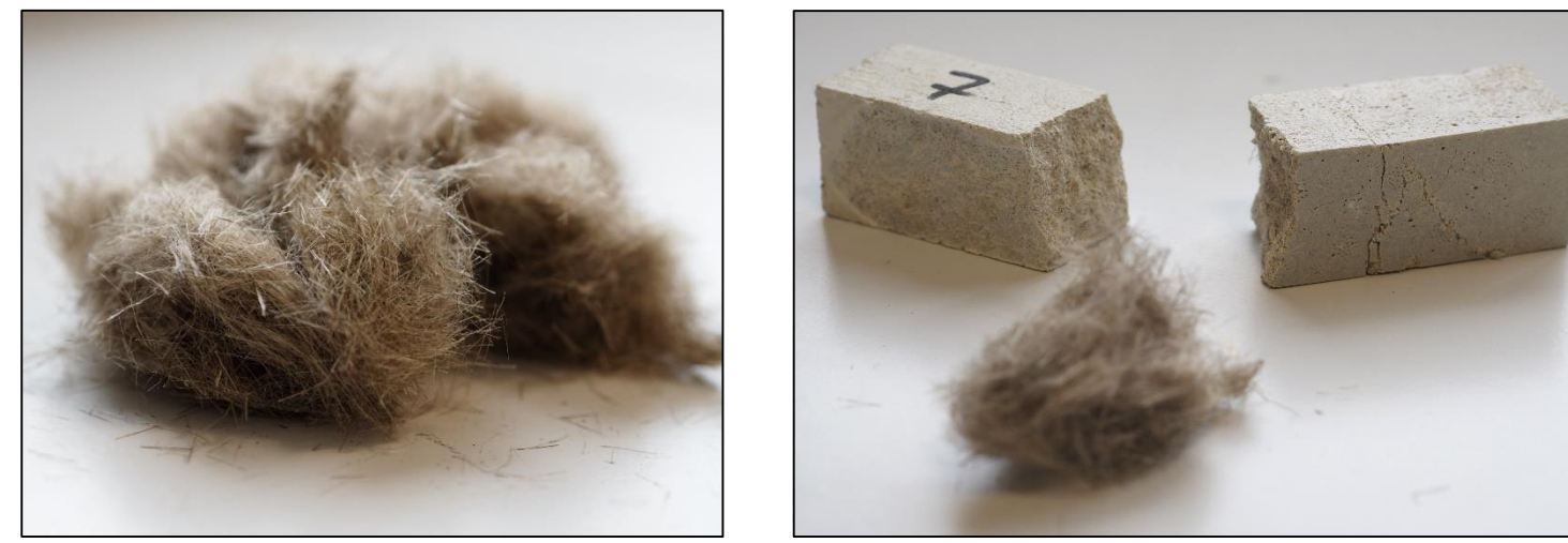
Fig. 3 : Fibres de lin et éprouvette de mortier
